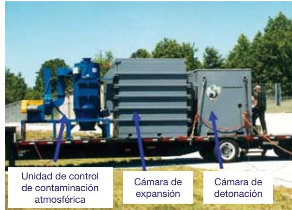
Imagen 4.6: Versión móvil de una cámara de detonación dotada de cámara de expansión así como de una unidad de control de contaminación atmosférica
