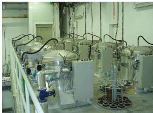
Imagen 6.1: Fusión de TNT con autoclaves en una factoría de destrucción de munición (Ankara) (imagen cedida por NAMSA)
