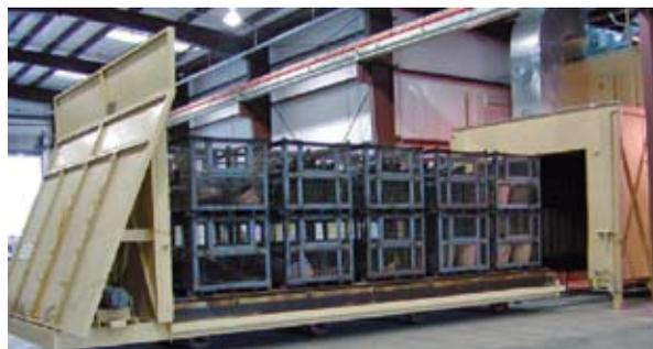
Imagen 4.5: Instalación de descontaminación mediante gas caliente. La vagoneta ha sido cargada con cestas metálicas que contienen munición que ya fue sometida previamente a otro tratamiento.
