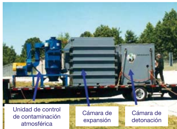
Imagen 4.6: Versión móvil de una cámara de detonación dotada de cámara de expansión así como de una unidad de control de contaminación atmosférica
