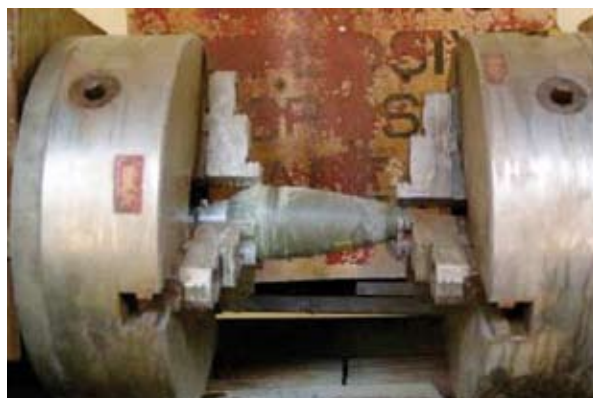
Imagen 5.2: Torno usado para el corte de un mortero de 81 mm
