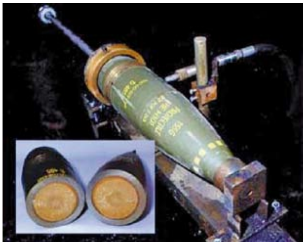
Imagen 5.3: Equipo de corte hidroabrasivo; imagen inferior izquierda: resultado del corte de una munición de 155 mm
