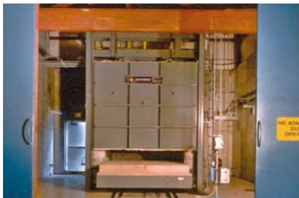
Imagen 4.4: Horno de solera móvil con la compuerta entreabierta
