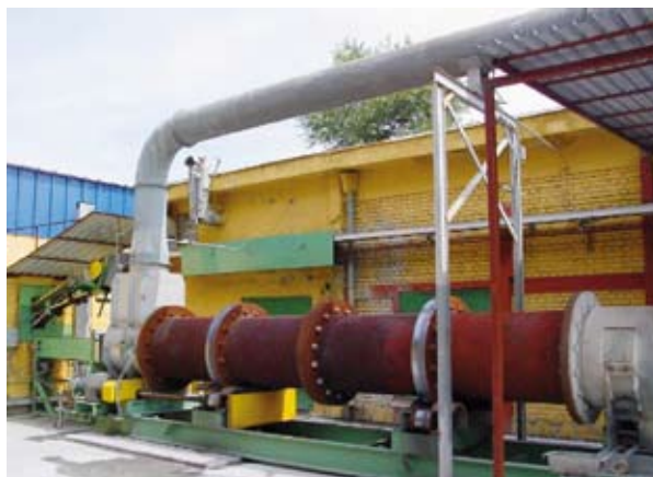
Imagen 4.1: Vista exterior de un horno rotatorio (imagen cedida por NAMSA)
