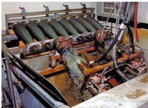
Imagen 6.3: Vaciado de proyectiles de 155 mm con chorro de agua
