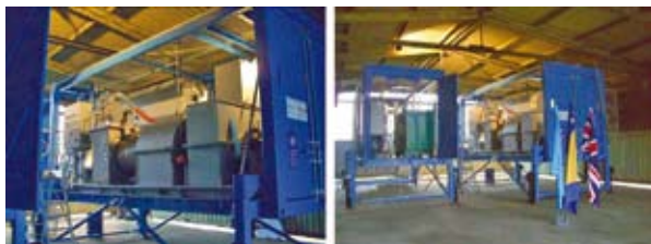
Imagen 4.2: Sistema de Destrucción de Munición Transportable con contenedores usado por el PNUD en Bosnia
