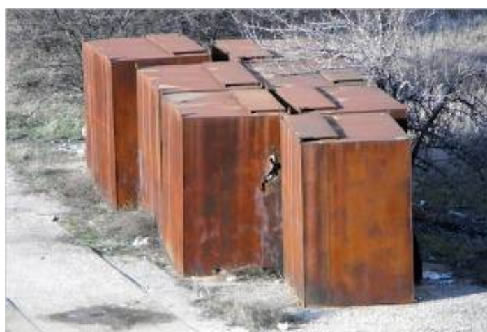
Целостность контейнеров с асбестовыми отходами с корабля «Юнайтед Стейтс» нарушена (Севастополь 2009)
