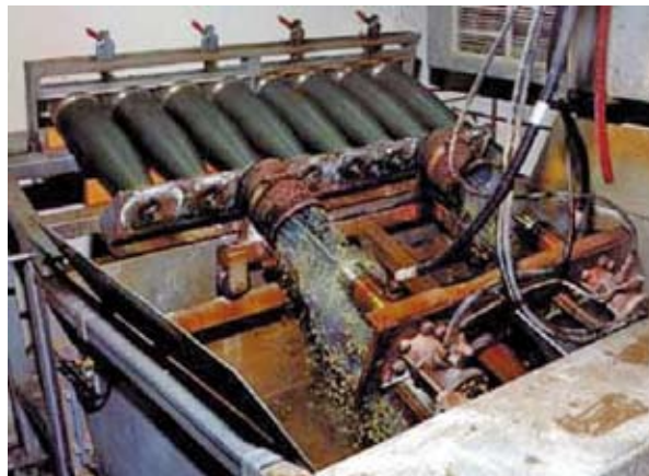
Figura 6.3: Lavaggio con getto d'acqua di proiettili da 155 mm
