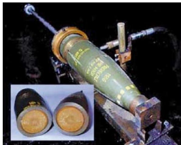
Figura 5.3: Attrezzatura per il taglio idroabrasivo. Nel riquadro in basso a sinistra, esempio di taglio su munizione da 155 mm.
