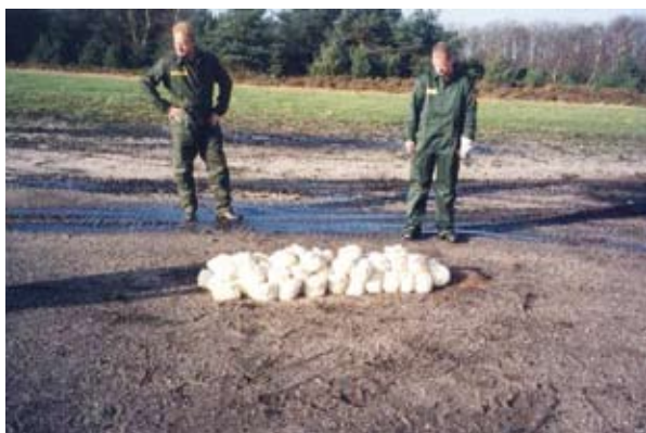
Figura 3.2: Sacchi contenenti propellenti pronti per la combustione a cielo aperto.
