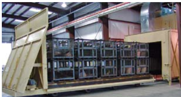
Figura 4.5: Impianto di decontaminazione a gas caldo. Sul carrello vengono posizionati cestelli metallici carichi di munizioni pretrattate.
