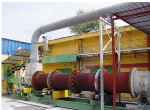
Figura 4.1: Visione esterna di un forno rotativo (per gentile concessione NAMSA)
